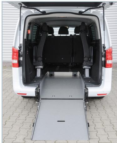
Bei ausgeklappter Rampe kann das Fahrzeug bequem mit dem Rollstuhl befahren werden.
